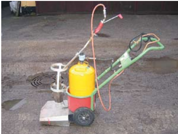
Lille kærrebrænder. Benytter luftformig gas
