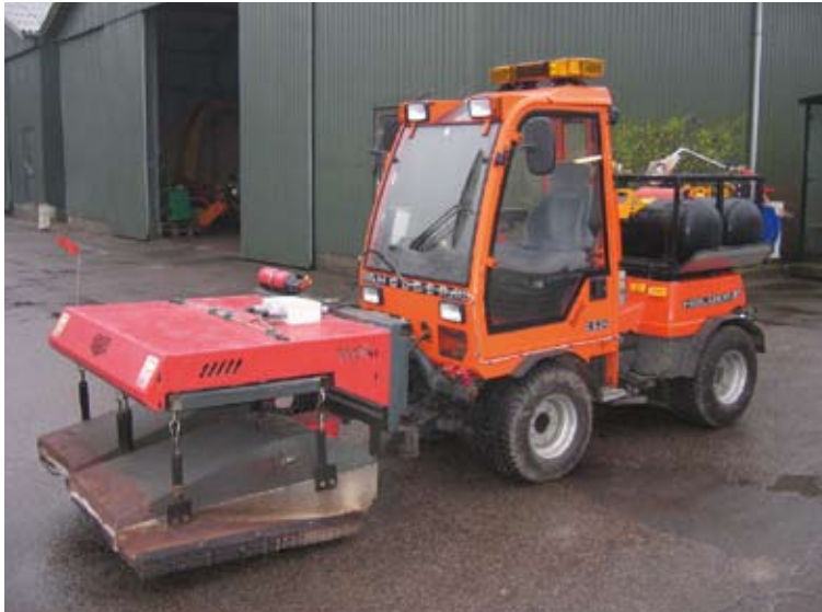
Eksempel på traktormonteret gasbrænder
