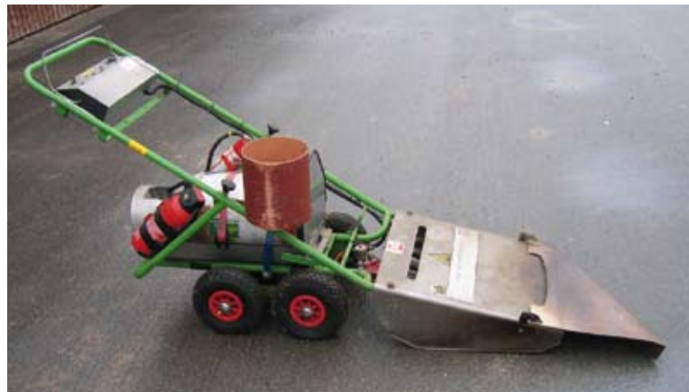
Større kærrebrænder. Benytter flydende gas
