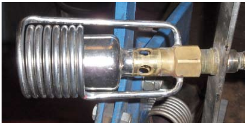
Væskebrænder med fordamperrør
