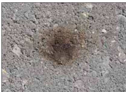
Forskellige former for jernudfældninger. Nogle typer forsvinder med tiden, andre gør ikke.
